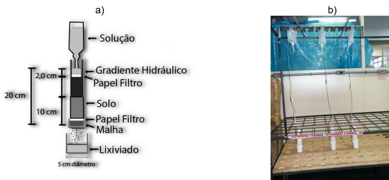
Figura 1. Representação da Coluna PVC; a) esquematização da coluna; b) representação em loco.
