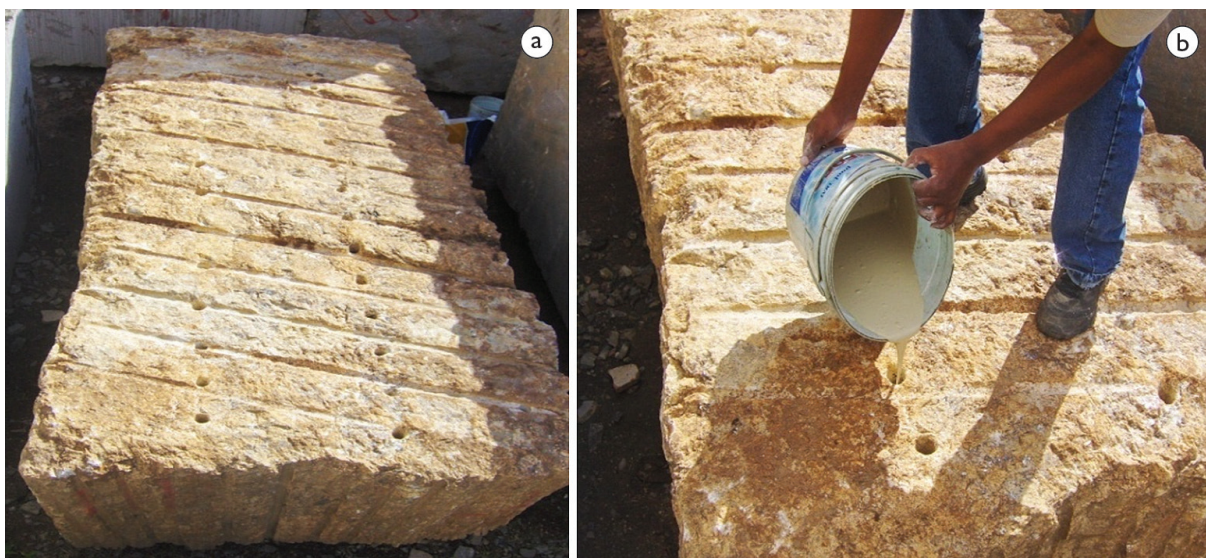
Figura 1. (a) Perfurações no bloco; (b) Aplicação da argamassa no bloco [3].
