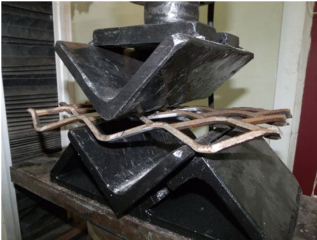
Figura 3. Montagem do ensaio de dobramento.
