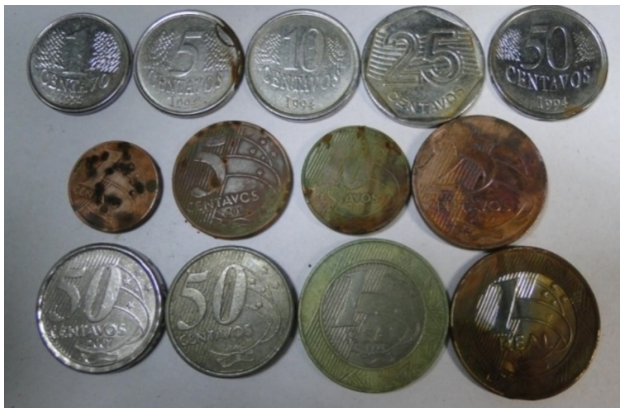
Figura 9. Conjunto 15, moedas imersas em solução salina por 145 dias.
