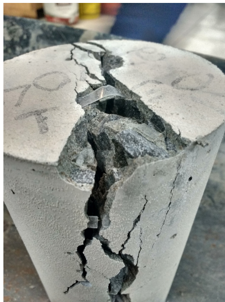
Figura 4. Corpo de prova após a ruptura na prensa.
