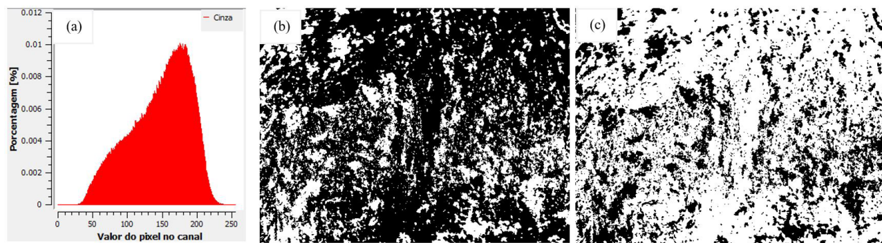
Figura 7. Processamento da Imagem da Figura 3b: (a) Histograma de 8 bits; (b) Imagem binarizada; (c) Imagem binarizada invertida.
