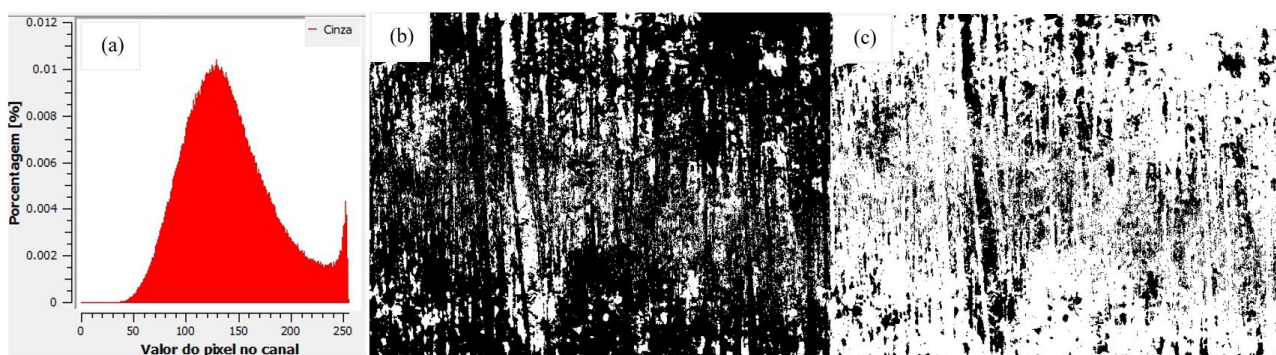
Figura 6. Processamento da Imagem da Figura 3a: (a) Histograma de 8 bits; (b) Imagem binarizada; (c) Imagem binarizada invertida.
