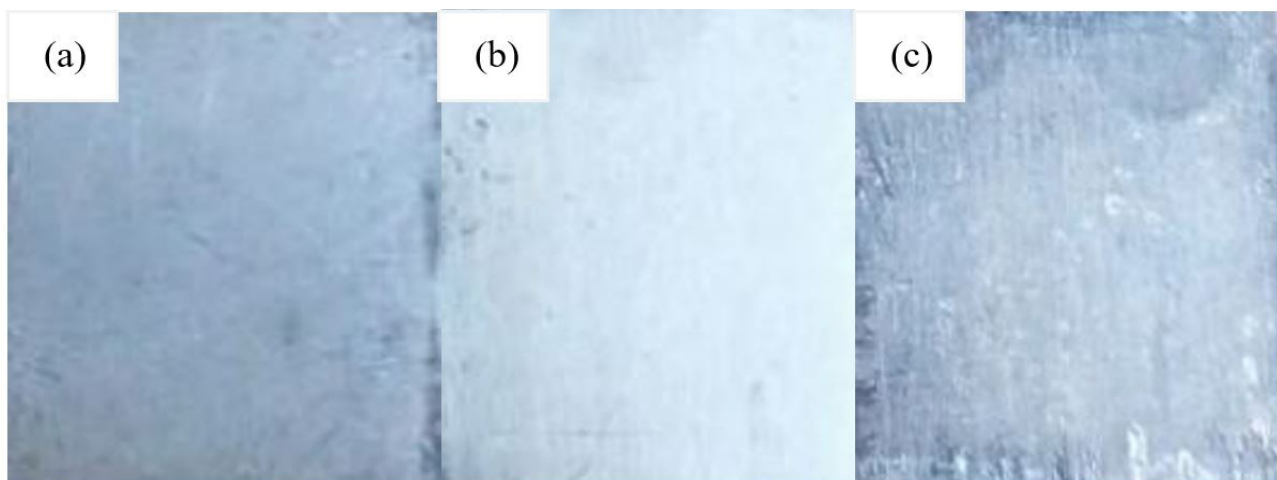
Figura 4. (a) Substrato de aço inox 304; (b) Amostra Galvanizada por Níquel Brilhante; (c) Amostra galvanizada por Níquel Fumê.
