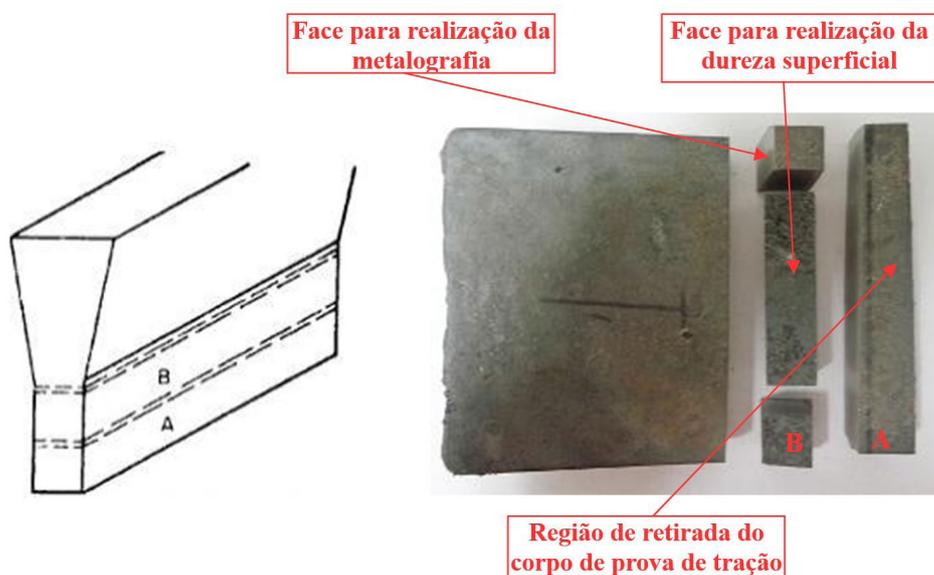
**Figura 1.** Local de retirada dos corpos de provas no bloco Y, A e B locais preferenciais para retirada das amostras.
