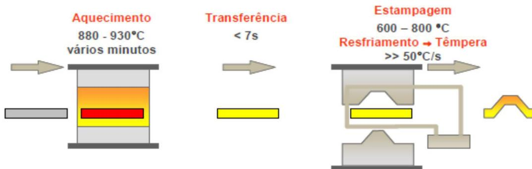
Figura 1. Representação esquemática das etapas do processo de estampagem a quente [2].
