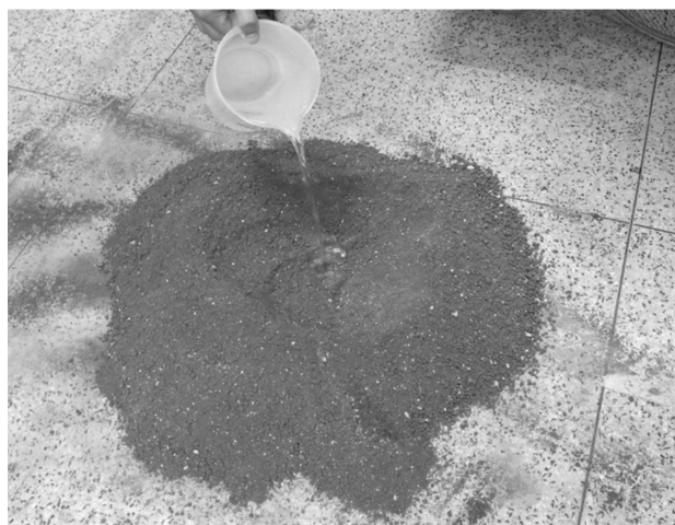
Figura 2. Dosagem dos materiais e adição de água para o amassamento da mistura.
