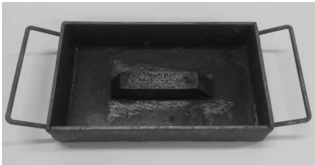
Figura 1. Fôrma utilizada na moldagem dos tijolos.
