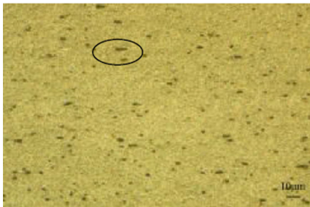
Figura 10. Microestrutura de uma chapa com espessura 0,30 mm, demonstrando a presença de partículas de segunda fase em formato de bastonete, liga 8079 [17].
