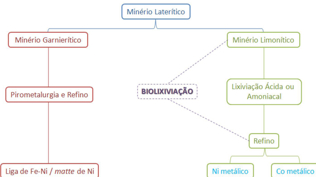
Figura 1. Esquema simplificado de rotas de processo de minério laterítico de níquel e cobalto.
