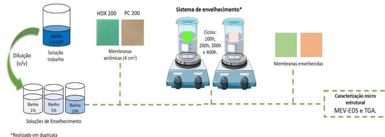
**Figura 1.** Representação esquemática do protocolo de envelhecimento das membranas aniônicas PC 200 D (24 amostras) e HDX 200 (24 amostras), ambas com  $4\text{ cm}^2$ , mantidas em contato com soluções de CuHEDP durante 100h, 200h 300 e 400h.
