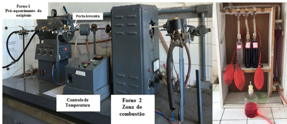
Figura 1. Simulador de injeção em altos-fornos e ORSAT para a análise dos gases.
