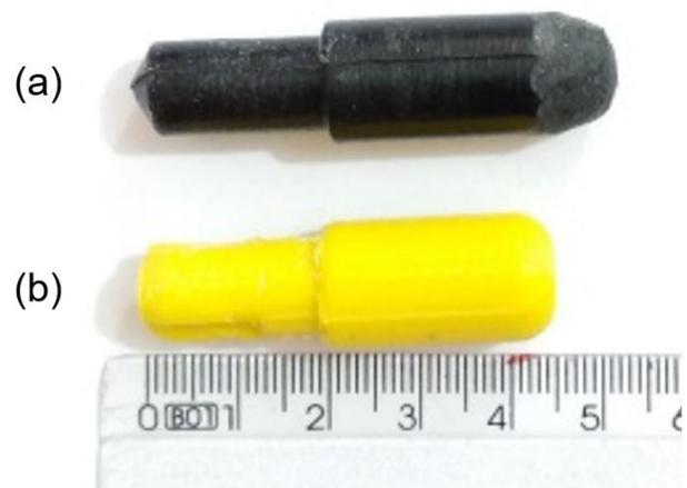
**Figura 2.** Ponteiras em compósito de matriz epóxi e 10%, em massa, de borracha de pneus (a) e construída em ABS por impressora 3D (b).
