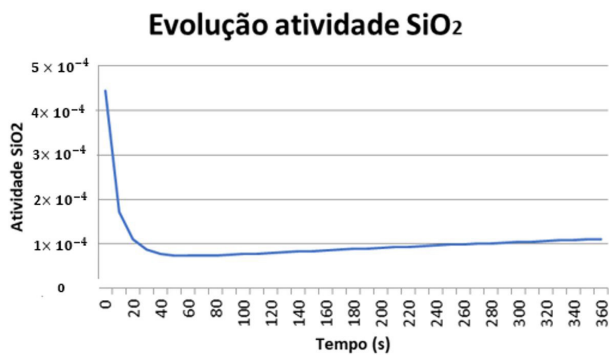
Figura 8. Variação calculada da atividade da sílica desde o vazamento do FEA até a chegada ao forno panela na corrida 1 (Tabela 4).
