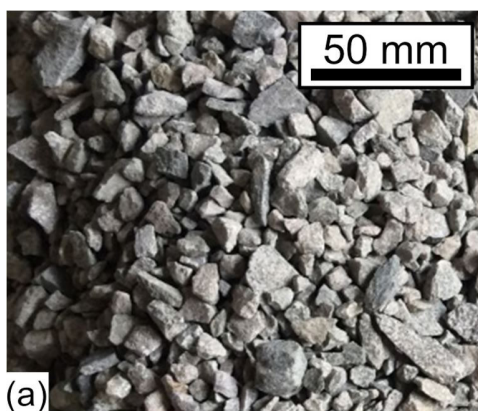
Figura 2. Materiais para a execução dos concretos. (a) Agregado graúdo natural (brita); (b) Resíduo da casca cerâmica após peneirado em faixas granulométricas semelhante ao agregado natural.
