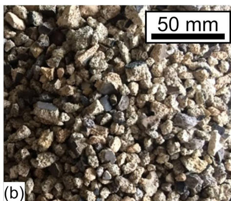
Figura 2. Materiais para a execução dos concretos. (a) Agregado graúdo natural (brita); (b) Resíduo da casca cerâmica após peneirado em faixas granulométricas semelhante ao agregado natural.
