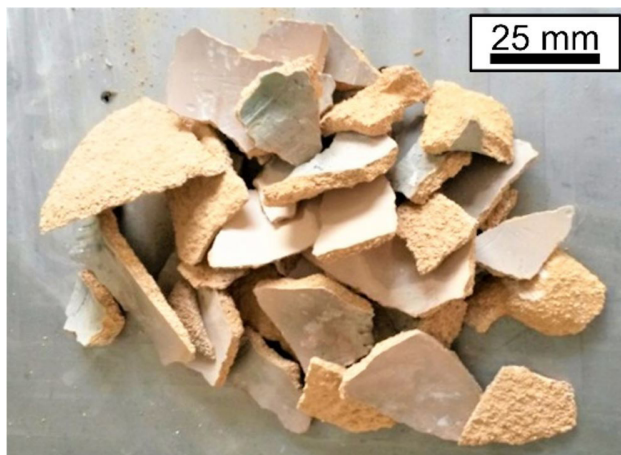
Figura 1. Resíduo de casca cerâmica em forma de lascas proveniente do processo de Fundição de precisão.
