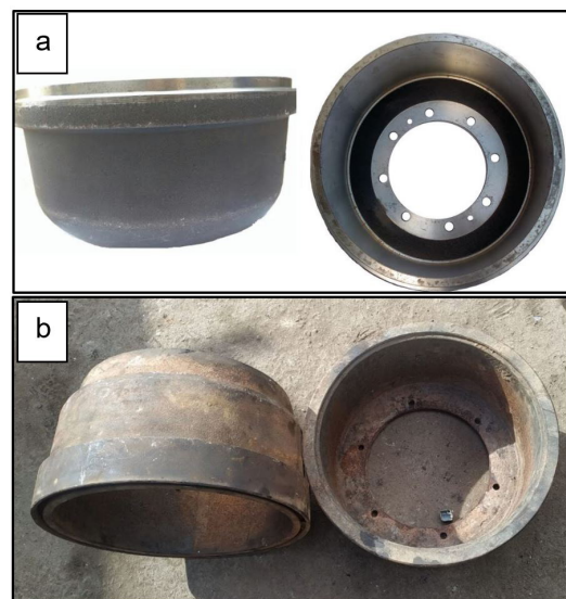
Figura 3. Tambores de freio: (a) novo; (b) usado.
