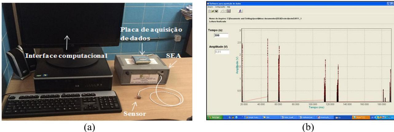
Figura 2. (a) Equipamentos que formam o Sistema de emissão acústica – SEA; (b) Analisador de sinais de EA.
