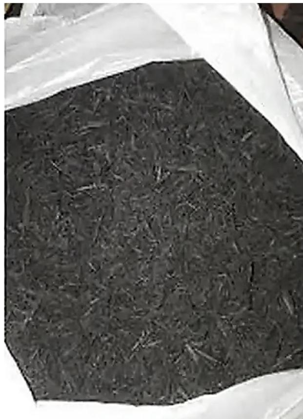
Figura 1. Resíduos de borracha de pneu utilizados.
