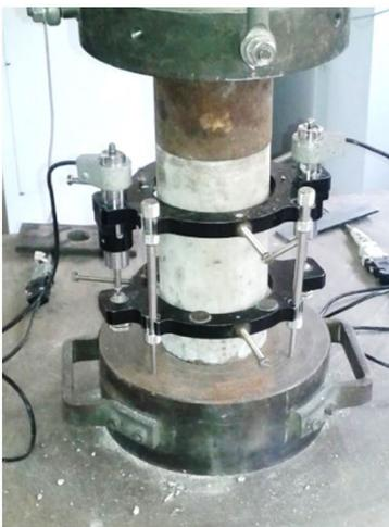
Figura 5. Ensaio de módulo de Deformação Longitudinal.
