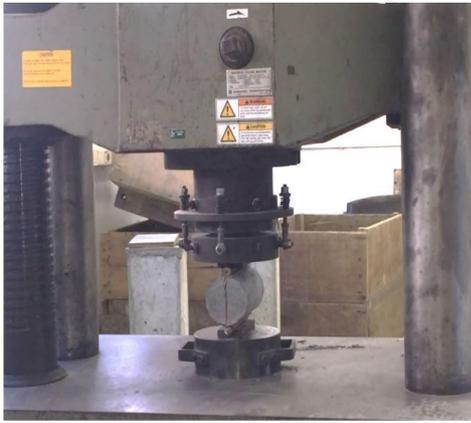
Figura 4. Ensaio de resistência à compressão diametral.
