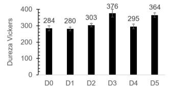
**Figura 4.** Dureza Vickers em função das condições do aço UNS S31803. D0: como recebido; D1: solubilizada a 1050 °C por 5 minutos; D2: Envelhecida a 800 °C por 20 minutos; D3: Envelhecida a 800 °C por 60 minutos; D4: Envelhecida a 900 °C por 20 minutos; D5: Envelhecida a 900 °C por 60 minutos.
