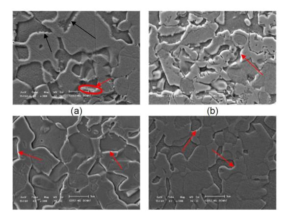
Figura 3. Micrografia de amostras envelhecidas: (a) 800 °C por 20 minutos; (b) 800 °C por 60 minutos, (c) 900 °C por 20 minutos e (d) 900 °C por 60 minutos.
