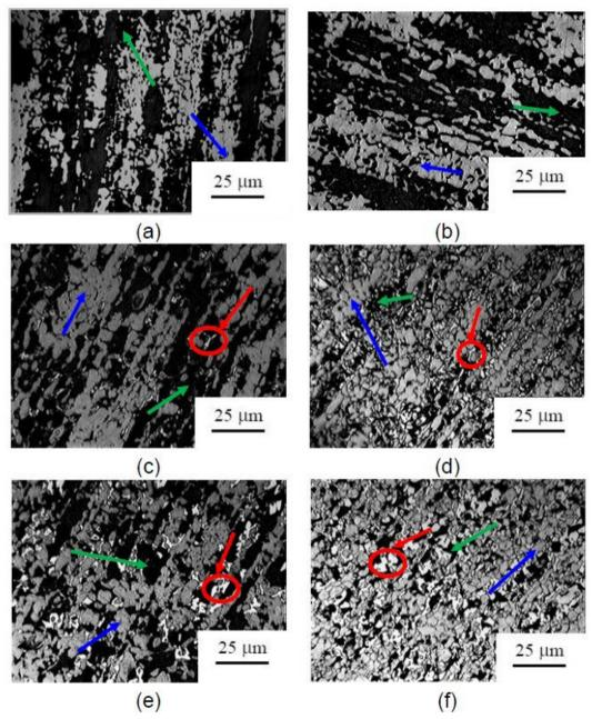
**Figura 1.** (a) Recebido, (b) Solubilizado a 1050 °C por 5 minutos, (c) Envelhecido a 800 °C por 20 minutos, (d) Envelhecido a 800 °C durante 60 minutos, (e) Envelhecido a 900 °C durante 20 minutos e (f) Envelhecido a 900 °C durante 60 minutos.
