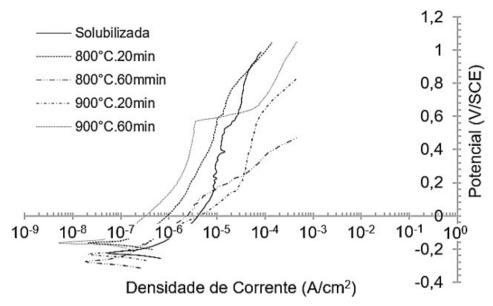
Figura 5. Curvas de polarização das amostras solubilizadas e envelhecidas aço UNS S31803.
