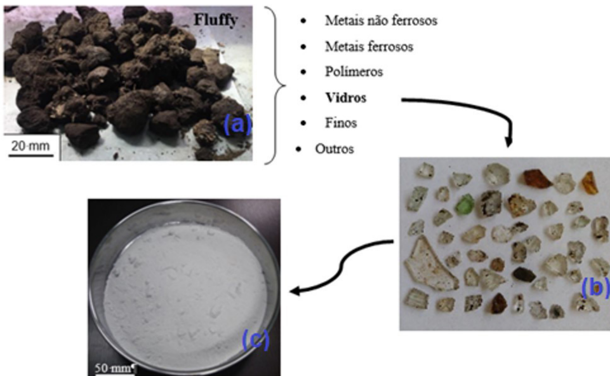
Figura 2. Imagem (a) rejeito da etapa de trituração de sucata em Shredder de indústria metalúrgica (Fluffy); (b) resíduos de vidro extraídos do Fluffy; e (c) pó de vidro obtido em moinho de alta atrição.
