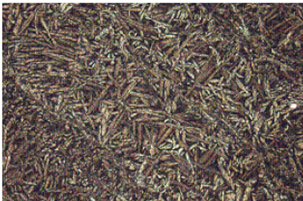
Figura 2. (a) Micrografia óptica do bronze de alumínio-níquel, apresentando morfologia Widmanstätten e com ampliação de 100x [1].
