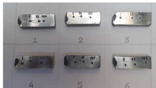
Figura 8. Crateras de desgaste geradas nos corpos-de-prova de aço-inoxidável ferrítico P410D, para a verificação da reprodutibilidade e da funcionalidade do equipamento “ball-cratering” projetado e construído.
