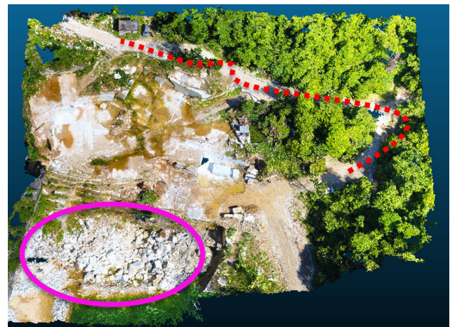
Figura 3. Vista superior da área de estudo; a linha pontilhada em vermelho representa a via de acesso à frente de lavra, enquanto o círculo rosa representa o local de deposição de estéreis.
