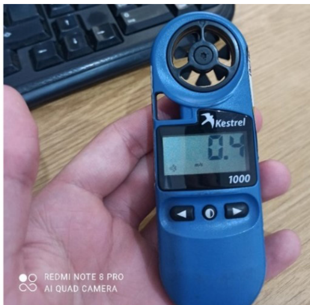
Figura 2. Anemômetro disponibilizado pela empresa. Fonte: Elaboração própria com consentimento da empresa.
