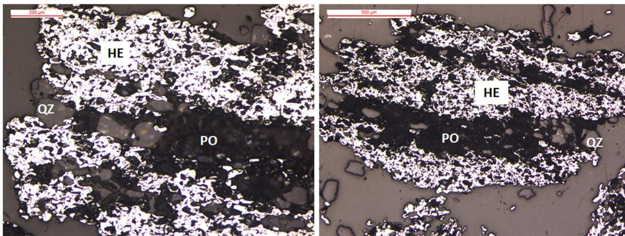
**Figura 1.** Fotomicrografias de partículas de itabiritos friáveis compostas por hematita (HE) e quartzo (QZ) com diferentes níveis de porosidade (PO) devido à lixiviação parcial do quartzo. Imagens dos autores.
