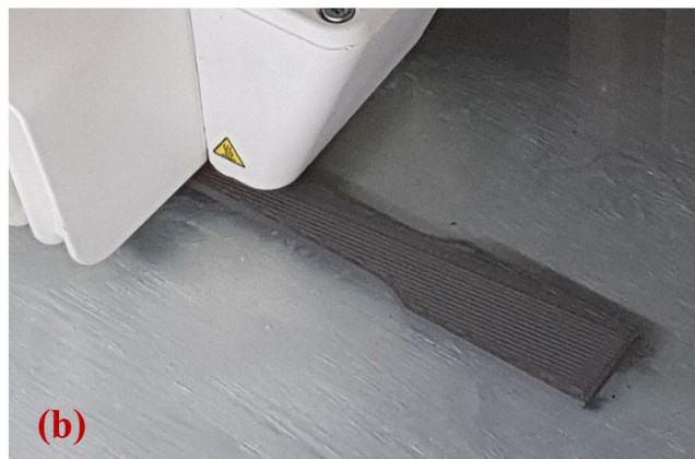
Figura 2. Representação da orientação de impressão das camadas: (a) visualização no software de fatiamento Ultimaker Cura e (b) detalhe da impressão na mesa.
