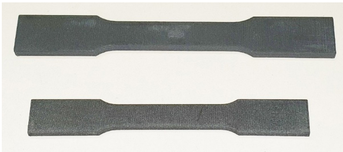
Figura 4. Comparação dos corpos de prova antes e após processos de debinding e sinterização.
