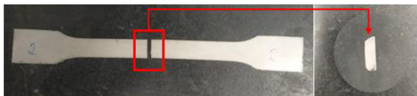
Figura 2. Corpo de prova para análise metalográfica após a fratura no ensaio mecânico de tração para 0^\circ , 45^\circ e 90^\circ em relação ao sentido de laminação.
