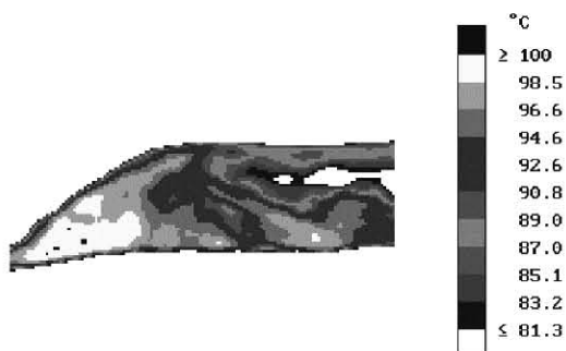
ESCÓRIA DA ACIARIA DE 0 A 10 MM, CURADA NO VAPOR COM 22 HORAS DE AQUECIMENTO. LADO 01. TEMP. MÁX.: 100 GRAUS. TEMP. MED.: 90 GRAUS.
