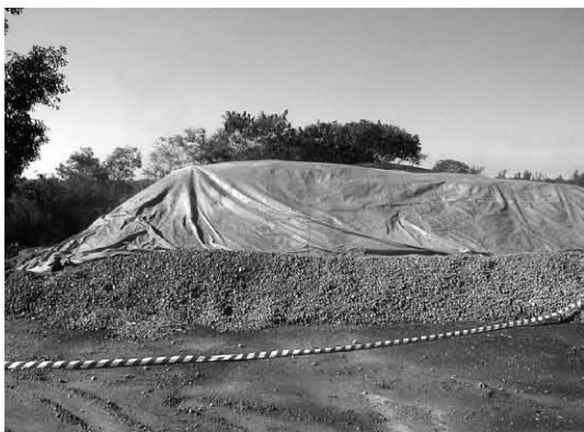
Figura 3. Pilha de escória de aciaria LD sendo curada com vapor d'água.
