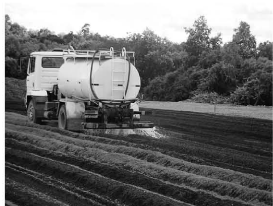
Figura 7. Produção Acerita® – hidratação da escória de aciaria
