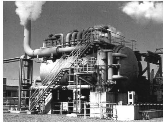
Figura 5. Autoclave desenvolvido pela Sumitomo e Kawasaki (Japão) para cura de escória de aciaria com vapor d'água a alta pressão
