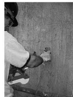
Fotografia 3. Registro da espessura de cobrimento das armaduras embutidas, por indução magnética. Ponto 02.
