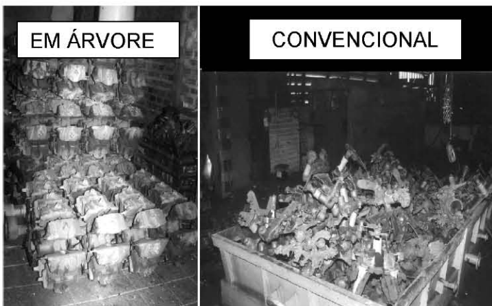
Figura 5. Comparação de empilhamentos de peças após desmoldagem. Verifica-se a maior facilidade de organizar e inventariar o estoque de processo.
