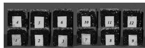
Figura 3. Refratários das diferentes composições após o ensaio de oxidação.
