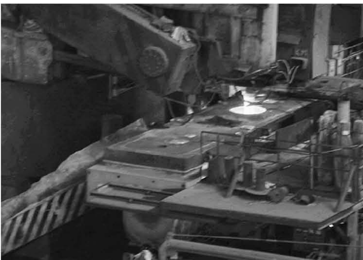
Figura 3. Distribuidor com tampas maciças (conjunto de 3 tampas) em operação.
