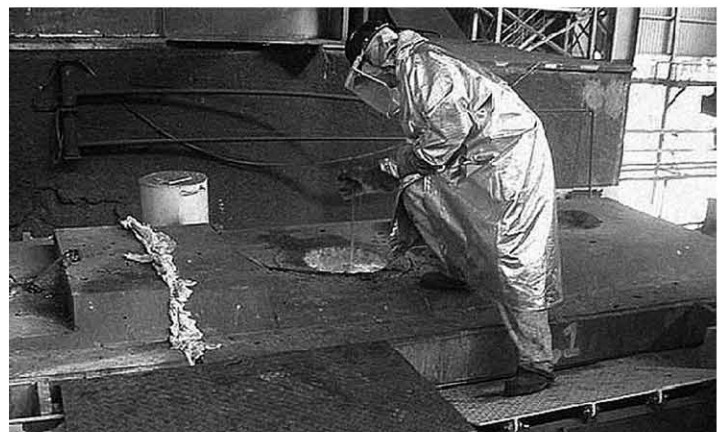
Figura 13. Coleta de amostra através da tampa refratada.
