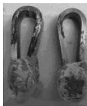
**Figura 3.** Corpos-de-prova de aço AISI 439 soldado com metal de enchimento de aço AISI 308; em soluções aquosas contendo 42%MgCl<sub>2</sub> (143°C); não ocorreu trincamento durante aproximadamente 200 horas de ensaio.
