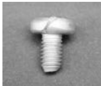
Figura 6. Exemplo de defeito formado no recalque da cabeça de parafusos.
