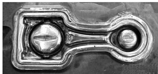
**Figura 7.** Matriz para forjamento a quente de biela, analisada no caso 2, em que o aço VHSUPER foi testado.
