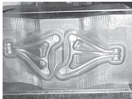
Produto: suporte de motor. Ferramenta: matriz de forjamento a quente. Material forjado: aço médio teor de carbono. Velocidade de aplicação dos golpes: lenta, típica de forjamento em prensa. Aço ferramenta utilizado anteriormente: AISI H13. Aço testado: TENAX 300. Ganho de vida útil obtido com a substituição: +40 %.
