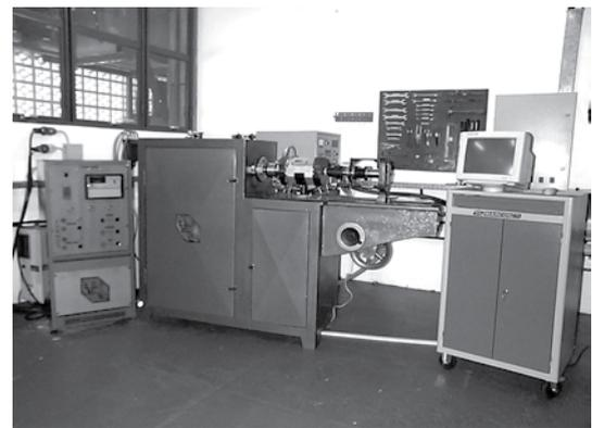
**Figura 4.** Equipamento utilizado para a realização dos ensaios de torção a quente.
