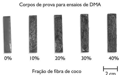
Figura 1. Corpos de prova dos compósitos incorporados com fibras de coco.
