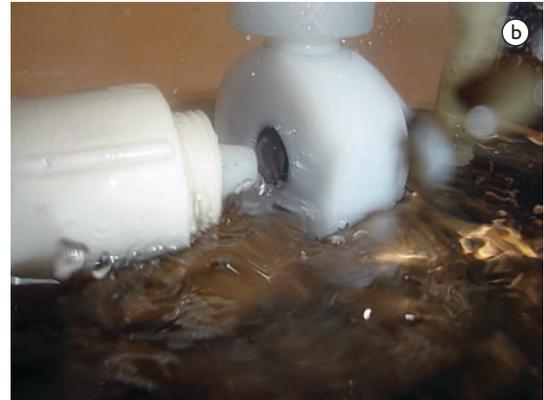
**Figura 1.** a) Esquema do equipamento usado nos ensaios de corrosão e erosão-corrosão; ET: eletrodo de trabalho, CE: contra-eletródo, ER: eletrodo de referência; e b) detalhe do bico e porta-amostras.
