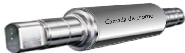
Figura 6. Representação da camada de cromo aplicada no cilindro de trabalho.
