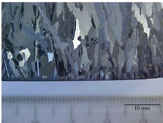
**Figura 3.** Detalhe da macrografia da seção longitudinal na base do lingote.
