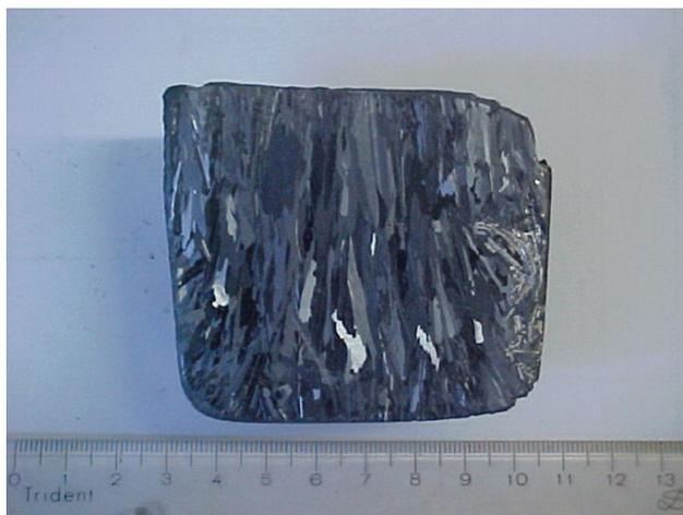
**Figura 2.** Macrografia da seção longitudinal do lingote obtido.
