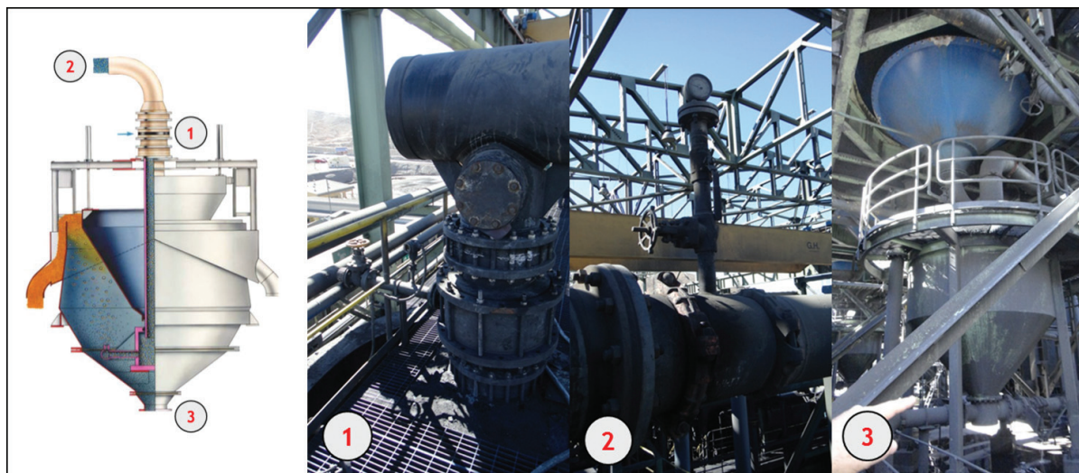
Figura 2. Figura ilustrativa de uma célula pneumática de flotação em escala industrial.
