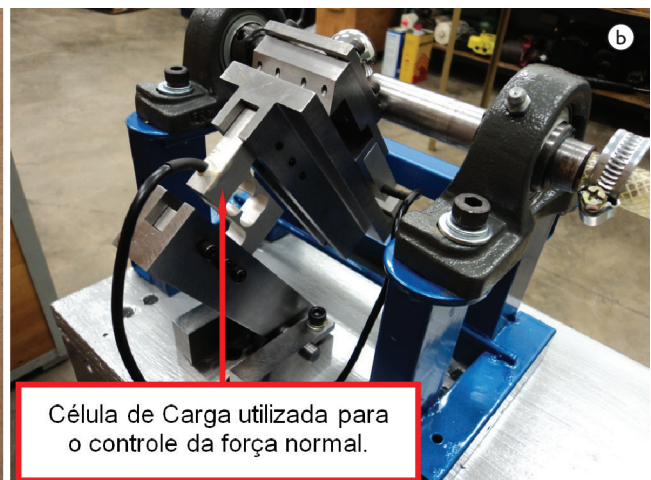
Figura 7. Células de carga destinadas ao controle da força normal e medição da força tangencial [15].
