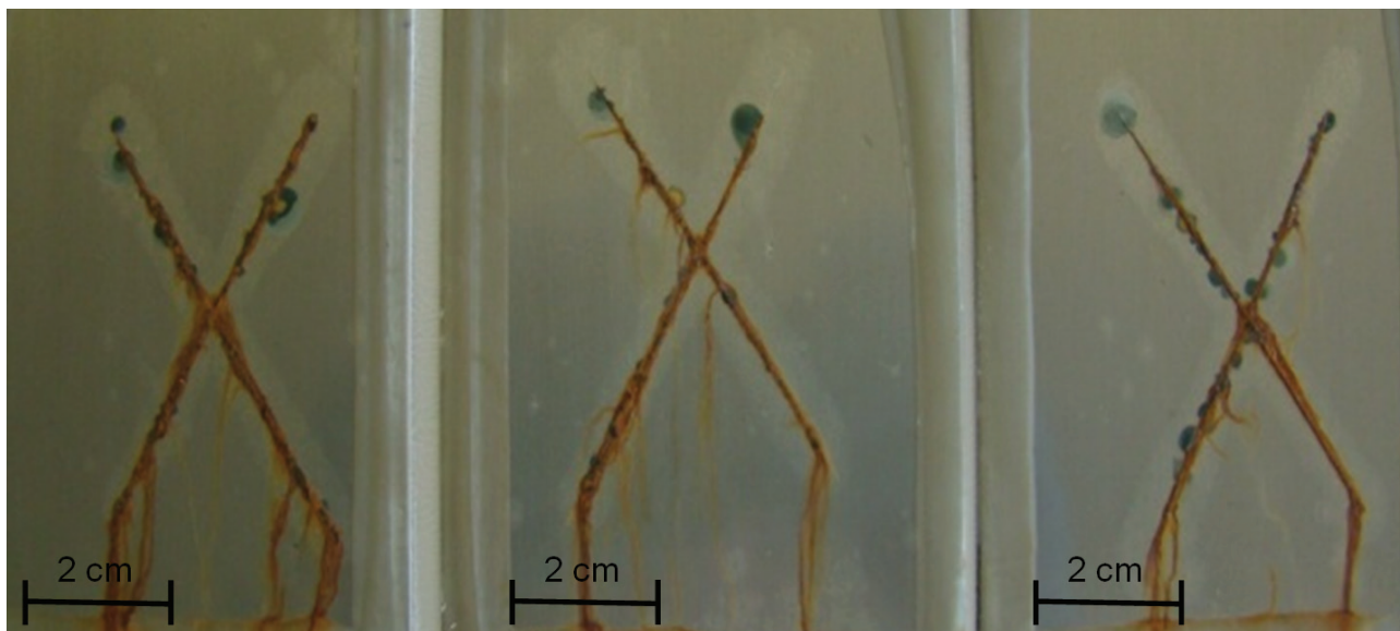
Figura 4. Aspecto das amostras TE/8/SMMT após 240 horas de exposição à névoa salina.
